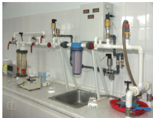
Fot. 2. Stanowisko do badania obciążania filtrów
