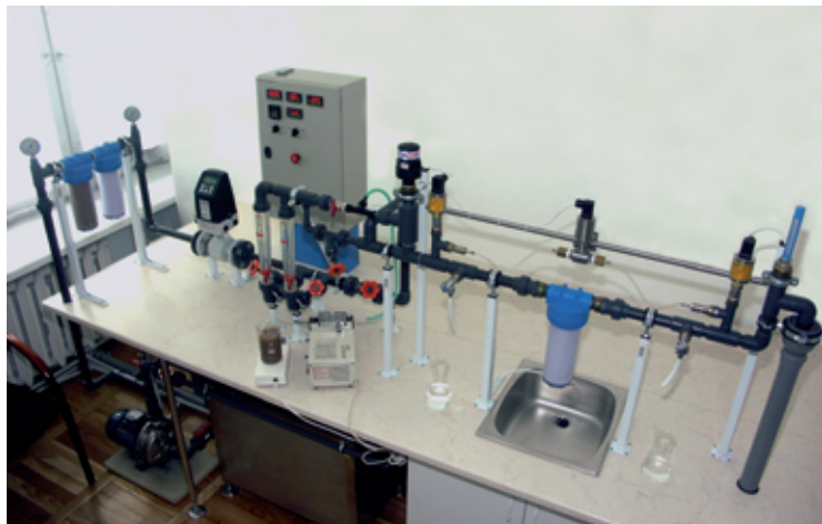
Fot.1. Laboracyjne stanowisko do badania skuteczności i oporów filtrów w firmie SECURA B.C.
