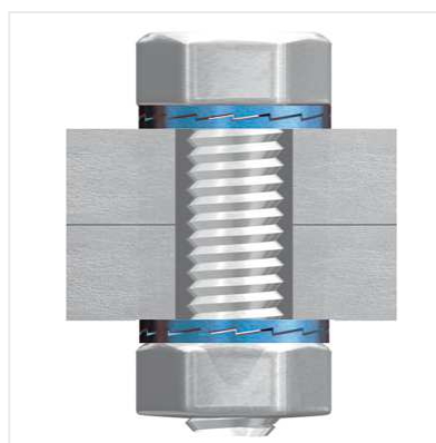
śruba / nakrętka (otwór przelotowy)
